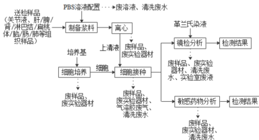
图 2-5 细菌学检测工艺流程及产污环节示意图
