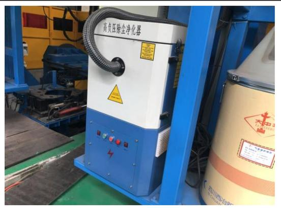
新增环形焊缝专机自带除尘装置
